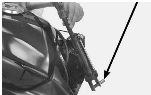
ROLAMENTO INFERIOR COLUNA DE DIREÇÃO EXTRATOR DE PISTA DE ESFERAS
