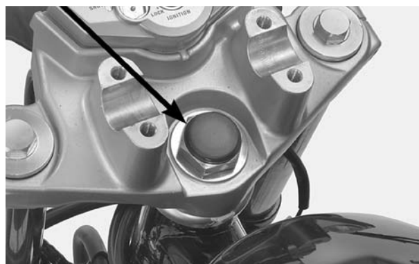
PORCA/ARRUELA DA COLUNA DE DIREÇÃO CAPA DA PORCA
