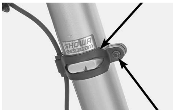
PARAFUSO/PORCA PARAFUSO SUPERIOR DO GARFO DA SUSPENSÃO
