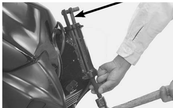
EXTRATOR DE PISTA DE ESFERAS
