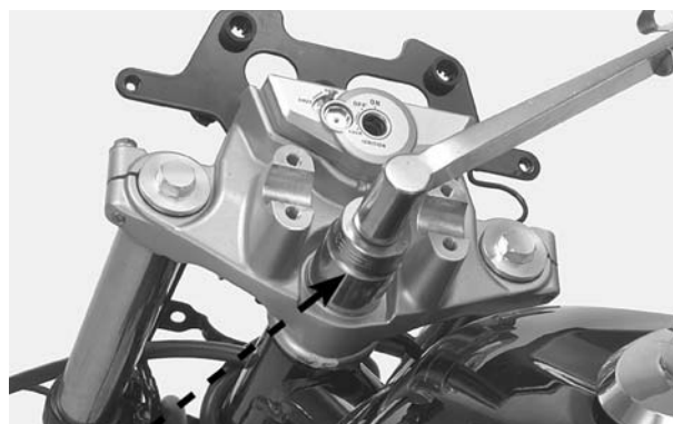
PORCA/ARRUELA DA COLUNA DE DIREÇÃO CAPA DA PORCA
